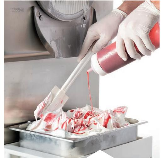
Gracias al invertir es posible **vetear el helado** en la cubeta sin detener la máquina o cerrar la puerta: la velocidad del agitador se puede reducir hasta la completa interrupción de la salida de helado, para permitir una cómoda distribución de los toppings; luego, aumentando la velocidad, el helado vuelve a salir.
