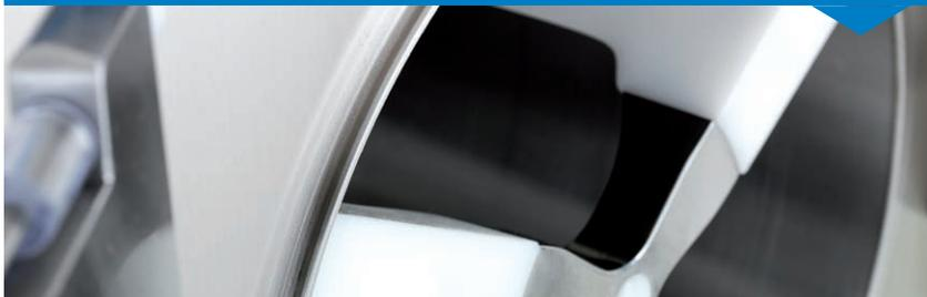
**Una vez completado el lavado, puede eliminarse del cilindro cualquier residuo de humedad**, con el programa de secado, indispensable antes de realizar la cristalización del chocolate.
