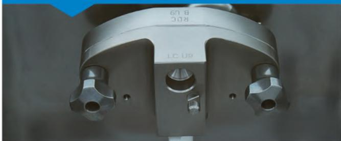
**Gravedad - Versión G.** Las distintas válvulas reguladoras dosifican naturalmente la mezcla con el aire para lograr un helado seco y compacto, y con un overrun de hasta el 40%. El cursor de regulación de la aguja permite, gracias a los foros tanto en la parte inferior como en la superior, la regulación del overrun, aunque la cubeta esté llena.
