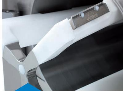
El agitador, sin eje central y con palas de **POM**, impenetrables al frío, permite la extracción completa del gelato; rígido y ligero, cuenta con rascadores auto-regulables para una constante limpieza y unas mejores prestaciones del cilindro.
