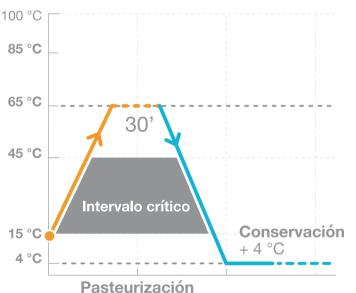
Estandar. A través del sistema automático de autopasteurización. es posible elegir cuando limpiar la máquina hasta un tiempo máximo de 42 días. Como garantía adicional de seguridad hygienica, si el operador no hace la limpieza integral al final de los días impostados, la máquina automaticamente se para.
