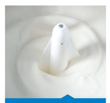
Agitador en la cubeta con velocidad regolable. Prevee la estratificación del producto a lo largo de la conservación y optimiza el intercambio termico durante la pasteurización.
